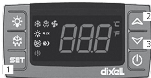
Abb. 3: Reglertyp DIXELL-Bedienelemente und Displayanzeigen (Symboldarstellung)
