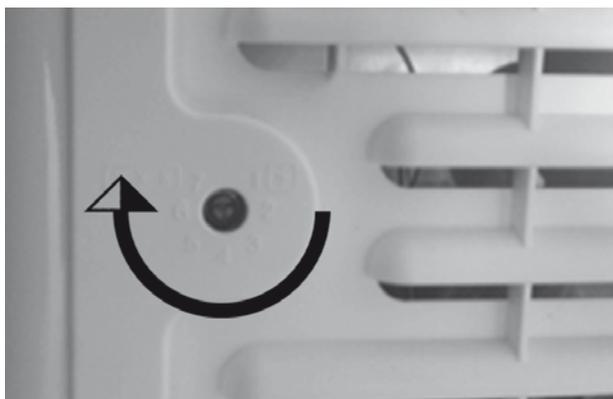
Abb. 2: Thermostateinstellung im seitlichen Lüftungsgitter
